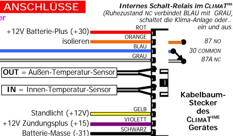
**Beispielhaftes Anschluss-Schema: Anschluss an eine manuelle Klima-Anlage.**
